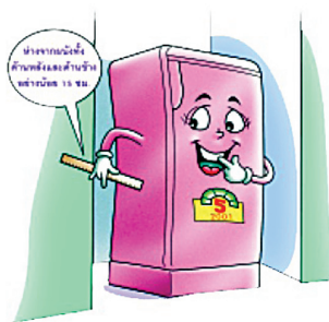
รูปที่ 3.3.11 วางตู้เย็นห่างจากผนังอย่างน้อย 15 ซม.
