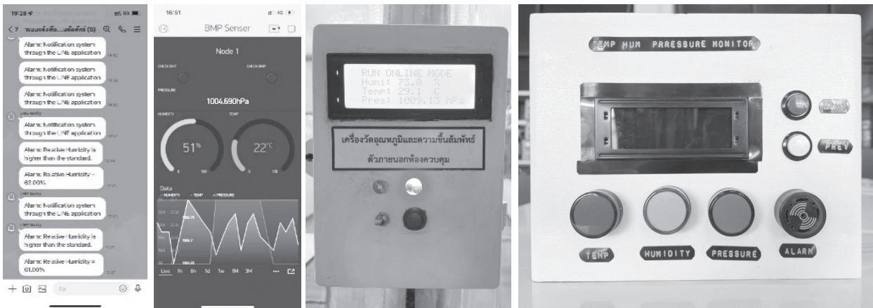
ภาพที่ 14 แสดงการแสดงผลค่าสภาวะอากาศภายในห้อง AIIR ผ่านระบบสื่อสารไร้สาย
