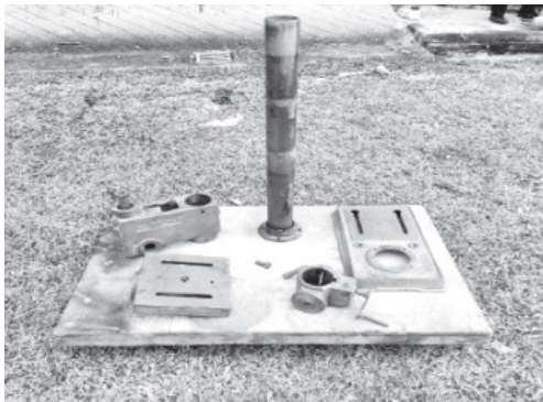
ภาพที่ 2 แยกชิ้นส่วนเครื่องเจาะตั้งโต๊ะ
