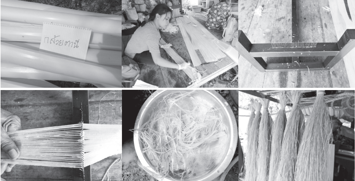
ภาพที่ 1 กระบวนการผลิตเส้นใยกล้วยจากกาบกล้วยตานี
