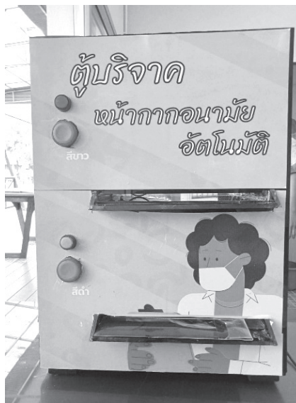
ภาพที่ 6 ตู้ให้บริการหน้ากากอนามัยระบบไฟแจ้งเตือนที่สมบูรณ์
