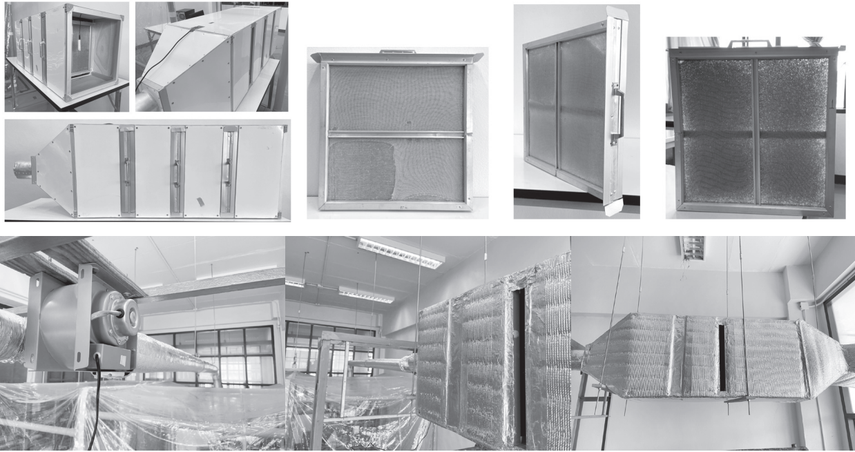
ภาพที่ 9 แสดงองค์ประกอบของระบบลดความชื้นด้วยสารดูดความชื้น silica gel
