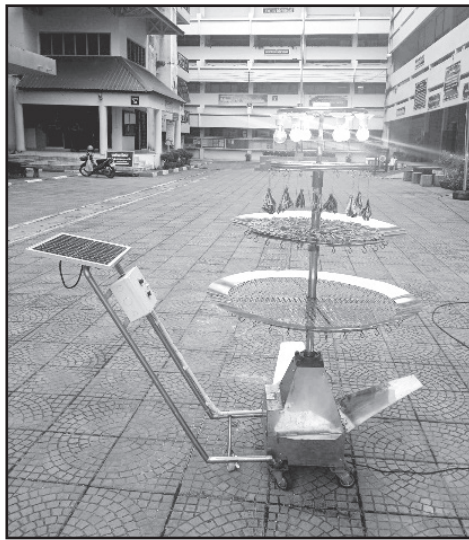
ภาพที่ 5 ทดลองใช้ชุดต้นแบบอุปกรณ์ตากปลาแบบหมุน
