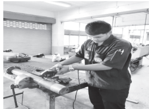
ภาพที่ 3 ตัดความยาวเสาให้มีความยาวเหมาะสม
