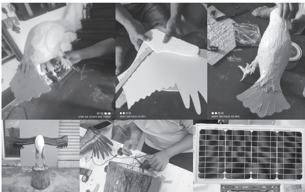
ภาพที่ 2 ขั้นตอนการสร้างการพัฒนาหุ่นไล่คนระบบอัตโนมัติโดยใช้พลังงานจากเซลล์แสงอาทิตย์
