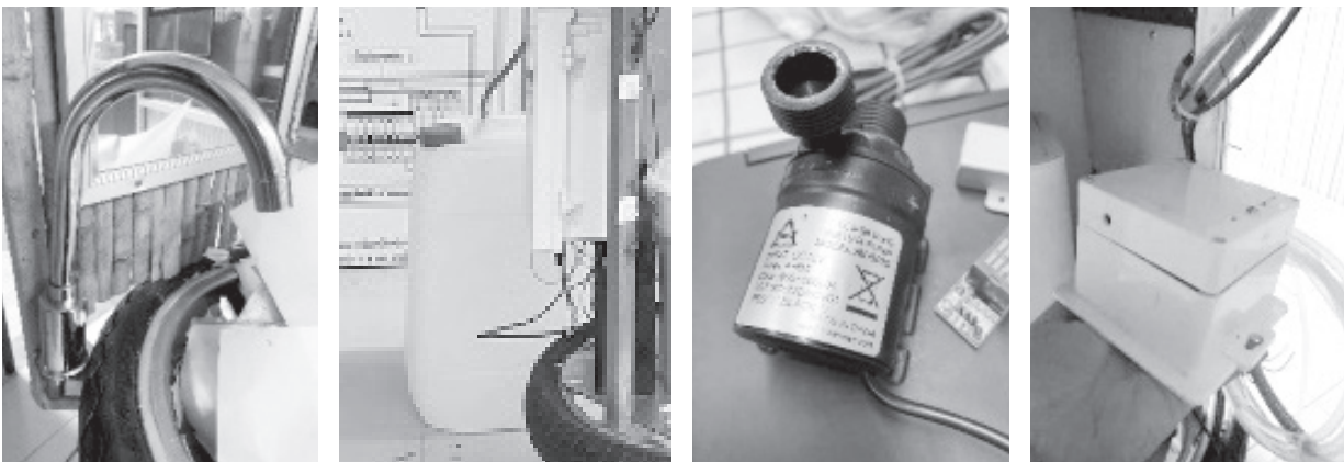
ภาพที่ 6 โครงสร้างส่วนของก๊อกน้ำอัตโนมัติ ปั้มน้ำและถังแกลลอนใส่น้ำสำรองขนาด 30 ลิตร
