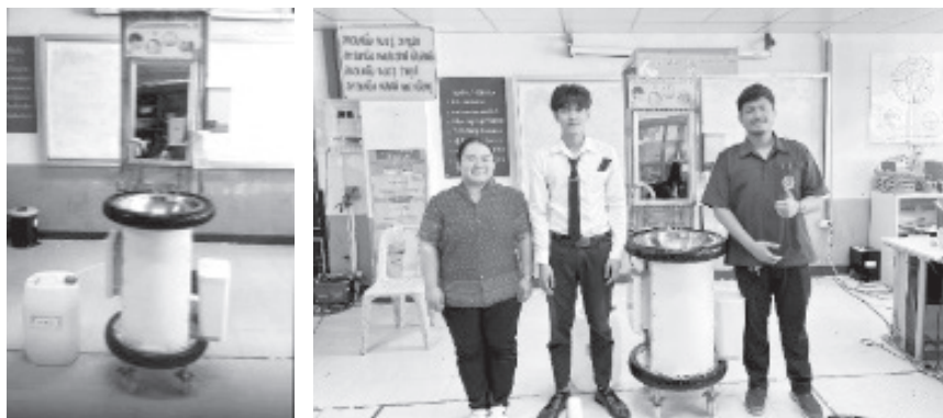
ภาพที่ 7 เครื่องต้นแบบของอ่างล้างมือเคลื่อนที่ที่เนกประสงค์
