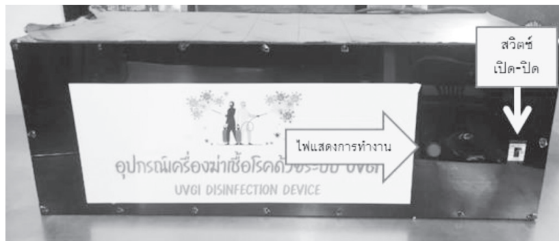
ภาพที่ 3 ปุ่มควบคุมการทำงานของอุปกรณ์ช่วยฆ่าเชื้อในอากาศ
