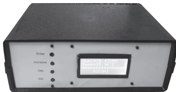
ภาพที่ 1 เครื่องควบคุมความชื้นด้วยแก๊สไนโตรเจนในตู้เก็บชิ้นงานอิเล็กทรอนิกส์
